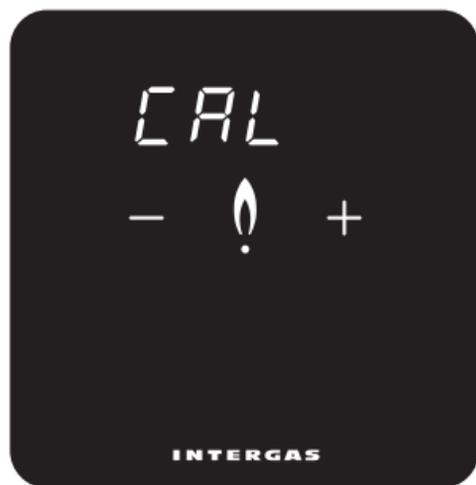
Stiskem tlačítka '+' nebo '-' se změřená teplota upraví až o +4 resp. -4 °C v krocích po 0,1 °C.
