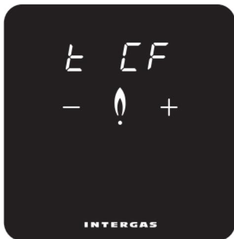
Výber požadovanej jednotky pre zobrazenie teploty, tj. stupňa Celsia alebo Fahrenheita.
