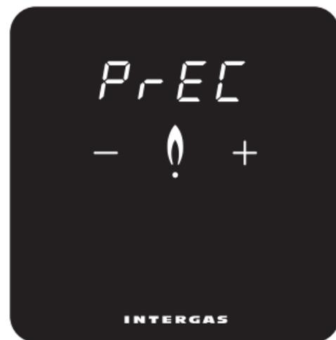
Con questa impostazione è possibile scegliere la risoluzione della temperatura ambiente rilevata. Impostando 0.1 la temperatura ambiente verrà visualizzata al decimo di grado, es. 20,2 – 20,3 ecc. Impostando 0,5 la temperatura ambiente verrà visualizzata con una risoluzione al mezzo grado.
