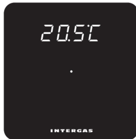
Het CV-toestel is in rust, er is geen warmtevraag. Nadat u de thermostaat heeft aangesloten is dit de standaard weergave op het display.
