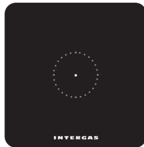
Active el modo de limpieza (bloqueo de pantalla temporal) tocando el punto durante 2 segundos. Limpie la pantalla del termostato. El bloqueo de pantalla se desactiva automáticamente después de 30 segundos y el termostato vuelve a funcionar con normalidad.
