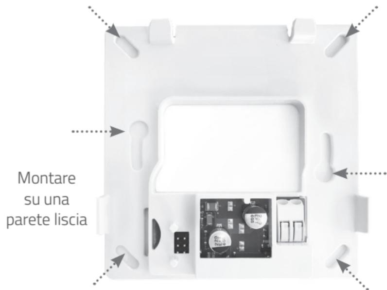
Per montare la piastra posteriore sulla parete utilizzare i 6 fori presenti con il materiale di fissaggio in dotazione. È possibile posizionare la piastra posteriore su una scatola di derivazione standard, in questo caso utilizzare le viti M3 presenti nella confezione.
