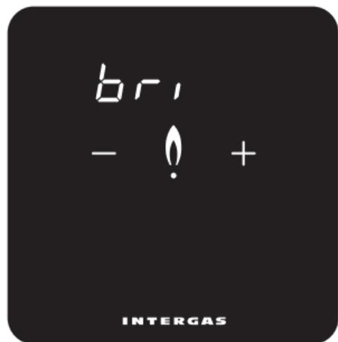
È possibile regolare l'intensità della luminosità del termostato
