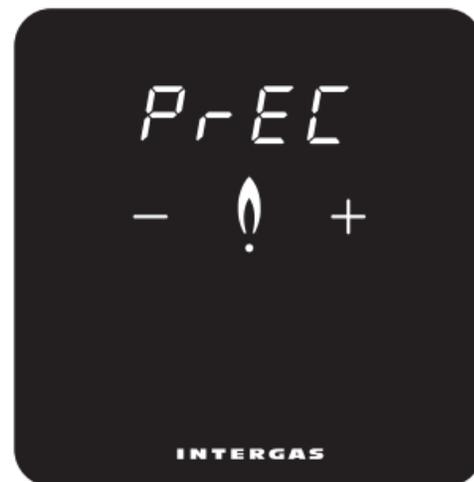
Πατήστε "+" ή "-" για να αλλάξετε τον τρόπο εμφάνισης της μετρούμενης θερμοκρασίας χώρου. **0,1**: Η μετρούμενη θερμοκρασία δωματίου εμφανίζεται σε 0,1 ° C. **0,5**: Η μετρούμενη θερμοκρασία δωματίου εμφανίζεται σε 0,5 ° C.
