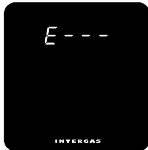
Indien een "E" met cijfercode wordt getoond is er sprake van een hardwarefout in de thermostaat. De thermostaat zal na 5 seconden herstarten. Indien deze fout zich voor blijft doen is de thermostaat defect en moet deze vervangen worden.
