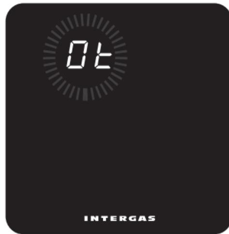
Komunikácia OpenTherm® medzi termostatom
