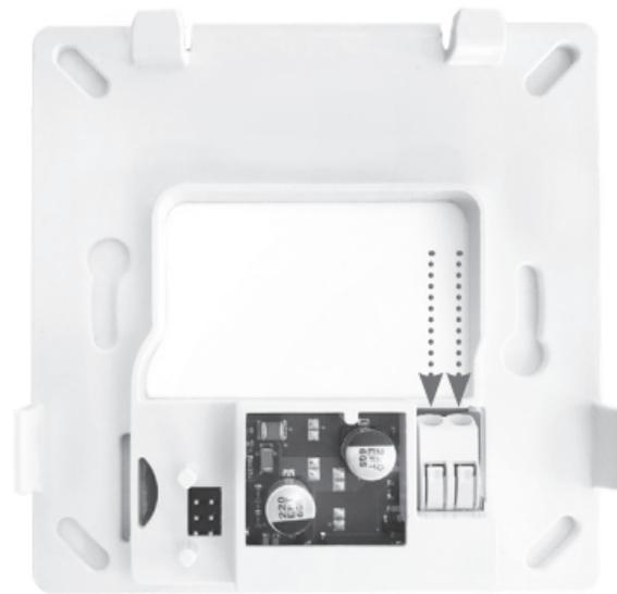
Sluit beide draden aan in de connector. De draaddikte mag tussen 0.2 t/m 0.75 mm<sup>2</sup> zijn. De bedrading "klikt" vanzelf vast. Het maakt voor de werking van de thermostaat niet uit hoe u de draden aansluit.
