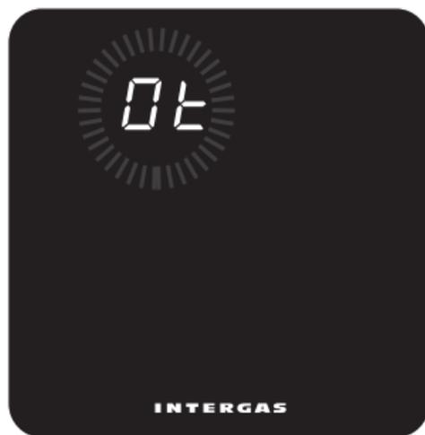
Non è disponibile il supporto Smart Power sulla caldaia. Il termostato non può funzionare con quel modello di caldaia.
