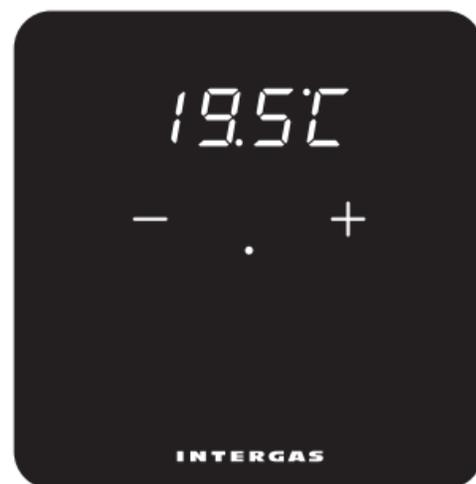
Krátkým klepnutím doprostřed obrazovky aktivujte tlačítka .+' a .-'. Pomocí těchto tlačítek nastavíte požadovanou teplotu.
