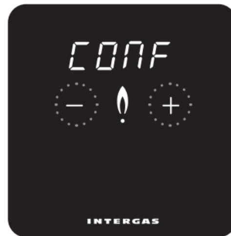
Súčasným stlačením tlačidiel .+' a .-' na dobu 2 sekúnd sa otvorí ovládací panel, na ktorom možno v prípade potreby upraviť nastavenie termostatu. K prechádzaniu ponúk slúžia tlačidlá .+' a .-'. Výber sa potvrdí stlačením bodky prostred displeja.
