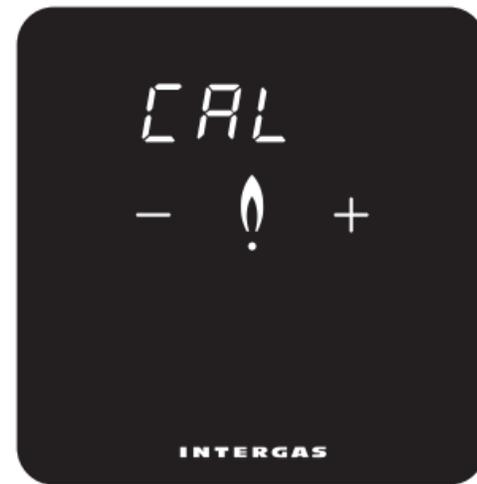
Stlačením tlačidla '+' alebo '-' sa nameraná teplota upraví až o +4 resp. -4 °C v krokoch po 0,1 °C. Zobrazená teplota nemusí zodpovedať skutočnej teplote, napr. vzhľadom na umiestnenie termostatu v miestnosti. Kalibráciou možno túto nepresnosť odstrániť.
