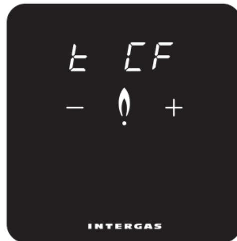
Επιλέξτε βαθμούς Celsius ή Fahrenheit ως μονάδα μέτρησης της θερμοκρασίας .
