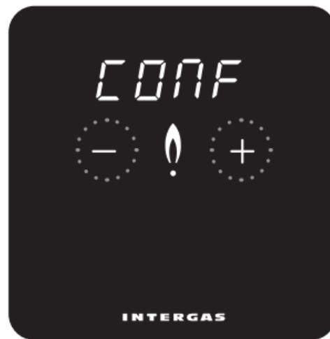
Toque los botones '+' y '-' simultáneamente durante 2 segundos para abrir el panel de control y ajustar la configuración del termostato, si es necesario. Recorra los menús tocando los botones '+' o '-'. Confirme las selecciones pulsando el punto central.
