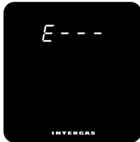
Se compare una "E" con codice numerico, c'è un errore hardware nel termostato. Il termostato si riavvierà dopo 5 secondi. Se questo errore persiste, il termostato è difettoso e deve essere sostituito.
