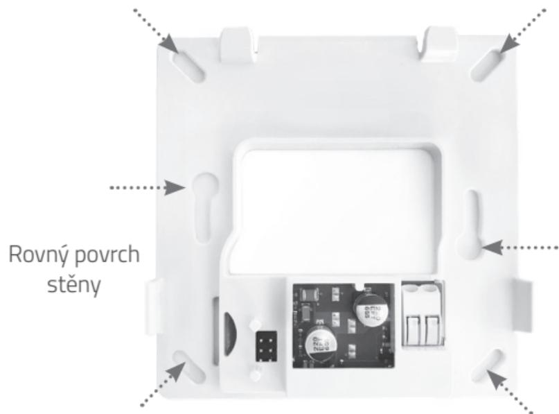
K upevnění zadní desky na zeď použijte hmoždinky a šrouby (součást balení). Pomocí šroubů M3, které jsou součástí balení, přišroubujte zadní desku ke standardní zapuštěné propojovací krabici.
