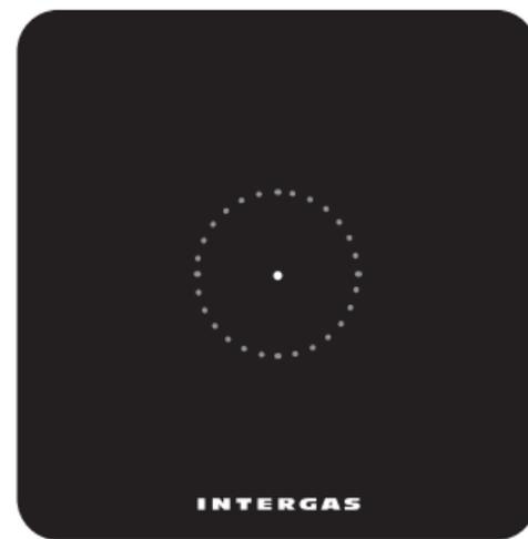
Režim čistenia (dočasné uzamknutie displeja) sa aktivuje stlačením bodky na dobu 2 sekúnd. Potom môžete displej termostatu vyčistiť. Za 30 sekúnd sa uzamknutie displeja automaticky deaktivuje a termostat sa vráti k normálnej prevádzke.
