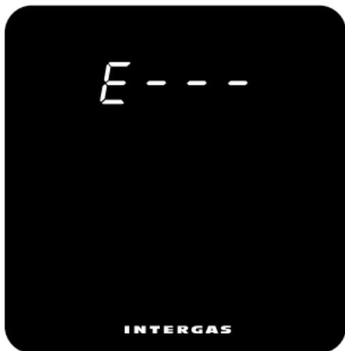
Ak sa zobrazí „E“ s číselným kódom, došlo k hardvérovej chybe termostatu. Termostat sa reštartuje po 5 sekundách. Ak táto chyba pretrváva, termostat je chybný a musí sa vymeniť.
