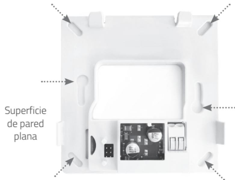
Use los tapones y los tornillos (suministrados) para fijar la placa posterior a la pared. Use los tornillos M3 (suministrados) para montar la placa posterior en la caja de empalmes empotrada estándar.
