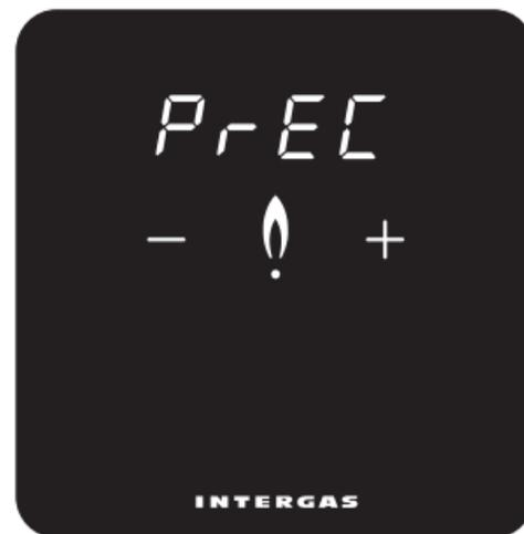
U kunt ervoor kiezen om de gemeten ruimtetemperatuur in tiende- of in halve graden weer te geven. **0.1:** De gemeten ruimtetemperatuur wordt in tiende weergegeven. **0.5:** De gemeten ruimtetemperatuur wordt op een halve graad afgerond.
