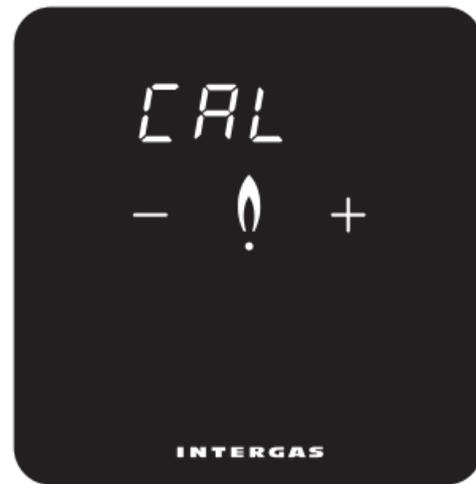
Toque los botones '+' o '-' para corregir la temperatura medida hasta en +4 o -4 °C, respectivamente, en incrementos de 0,1 °C. La temperatura mostrada puede no correlacionarse con la temperatura ambiente real, por ejemplo, debido a la posición del termostato en la habitación. Calibrar para compensar este efecto.
