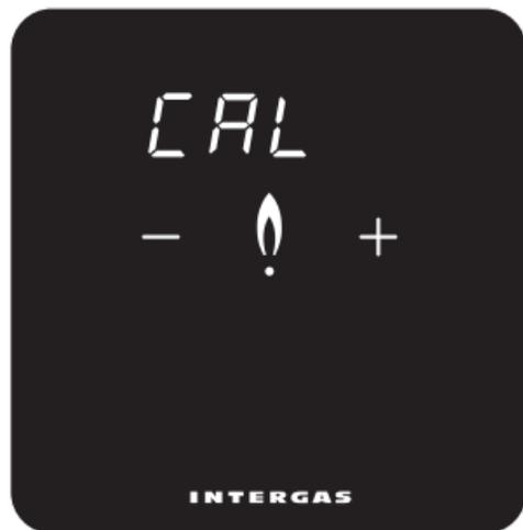
Πατήστε τα κουμπιά "+" ή "-" για να διορθώσετε τη μετρούμενη θερμοκρασία έως και +4 ή -4 °C αντίστοιχα, σε βήματα των 0,1 °C. Η εμφανιζόμενη θερμοκρασία μπορεί να μην συσχετίζεται με την πραγματική θερμοκρασία δωματίου, π.χ. λόγω της θέσης του θερμοστάτη στο χώρο. Βαθμονομήστε για να αντισταθμιστεί αυτό το αποτέλεσμα.
