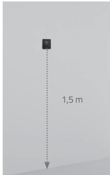
Τοποθετήστε τον θερμοστάτη σε σωστό ύψος. Αποφύγετε την τοποθέτηση θερμοστάτη στους εξωτερικούς τοίχους.
