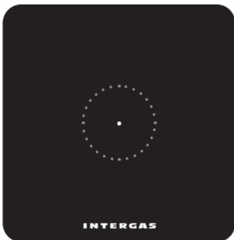
Režim čištění (dočasné uzamčení displeje) se aktivuje stiskem tečky na dobu 2 sekund. Potom můžete displej termostatu vyčistit. Za 30 sekund se uzamčení displeje automaticky deaktivuje a termostat se vrátí k normálnímu provozu.
