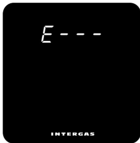
Si aparece un código numérico "E", hay un error de hardware con el termostato. El termostato se reiniciará después de 5 segundos. Si este error persiste, el termostato está defectuoso y debe ser reemplazado.
