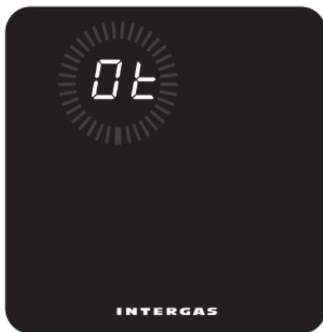
Er is geen correct werkende OpenTherm® communicatie tussen thermostaat en CV-toestel.
