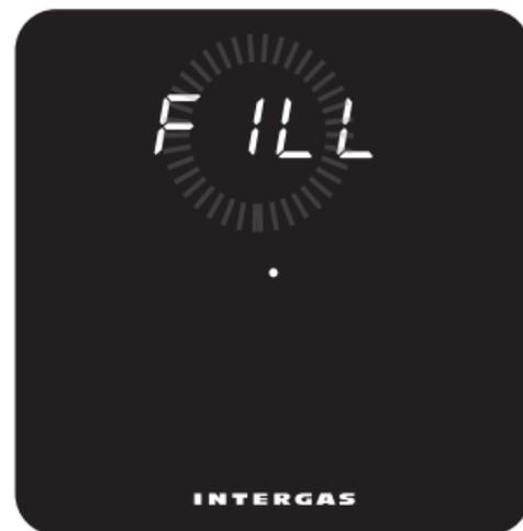
De cv-druk is te laag. De installatie dient bijgevuld te worden. Raadpleeg de handleiding van uw cv-toestel voor meer informatie.
