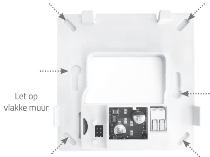
Voor de montage van de achterplaat op de muur zijn de benodigde pluggen en montageschroeven meegeleverd. Het is ook mogelijk de achterplaat op een standaard inbouwlasdoos te monteren. Gebruik hiervoor de meegeleverde M3-boutjes.
