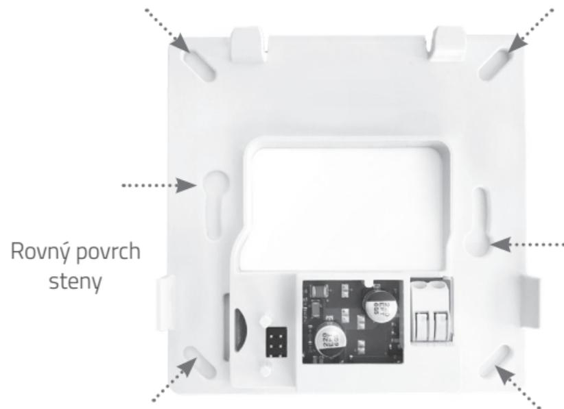
Na upevnenie zadnej dosky na stenu použite hmoždinky a skrutky (súčasť balenia). Pomocou skrutiek M3, ktoré sú súčasťou balenia, priskrutkujte zadnú dosku k štandardne zapustenej prepojovacej krabici.
