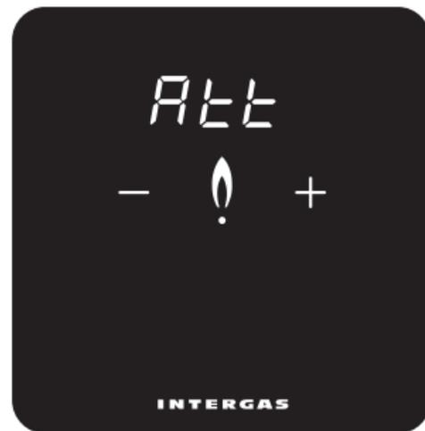
Ρυθμίστε την ένδειξη για να φωτίσετε κατά τη ρύθμιση της θερμοκρασίας από απόσταση. Ισχύει μόνο όταν χρησιμοποιείτε την εφαρμογή Comfort Touch.
